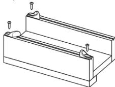
(5) Install a second guide on the other wall. Fixer le guide complémentaire sur le côté opposé.
